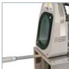
Tikslius elektrodo išikišimo reguliavimas.
